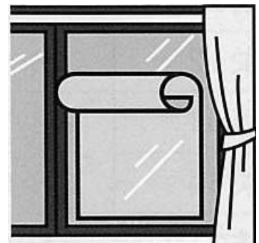
対策の一例：窓ガラスへの飛散防止シートの貼り付け
