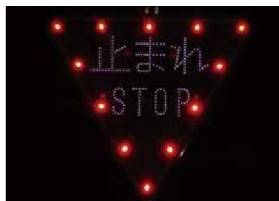
LED の自発光式一時停止標識
